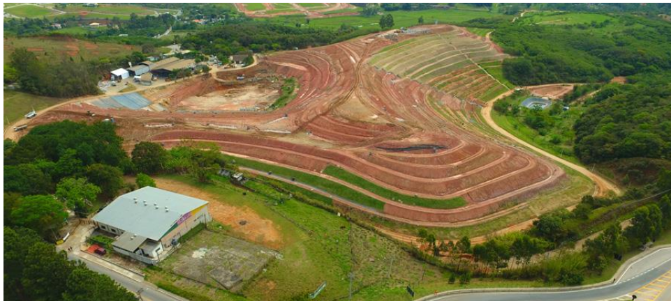
Figura 4: Aterro com o método de área.
