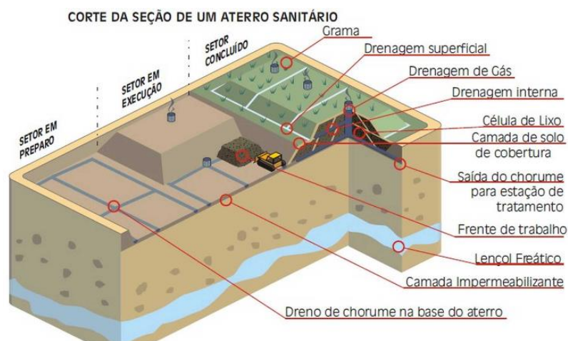
Figura 1: Corte da seção de um aterro sanitário.
