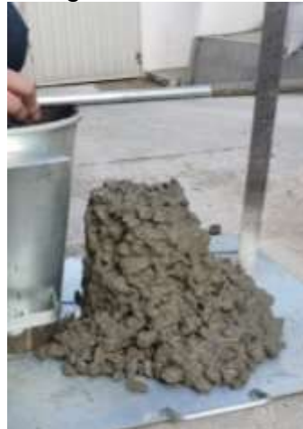
Figura 4 – Segundo Ensaio de Slump Test
