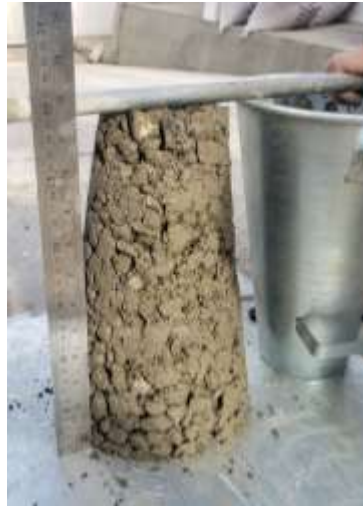
Figura 3 – Processo Final do Ensaio Slump Test
