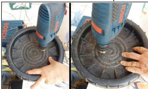
Figura 1 – Fazendo a Abertura na Tampa do Reservatório
